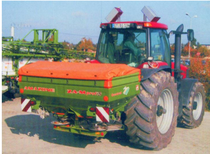
Рисунок 4 – Розкидачі AMAZONE із лазерним сенсором.
