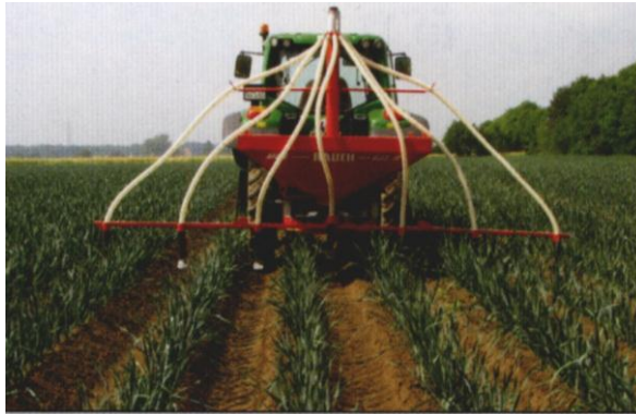
Рисунок 3 – Розкидач RAUCH з обладнанням для рядкового внесення добрив REZ 7 (семирядне).
