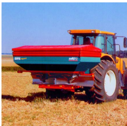
Рисунок 13 – Розкидачі фірми Sulku Burel S. A. з пристроєм для збільшення об'єму бункера.
