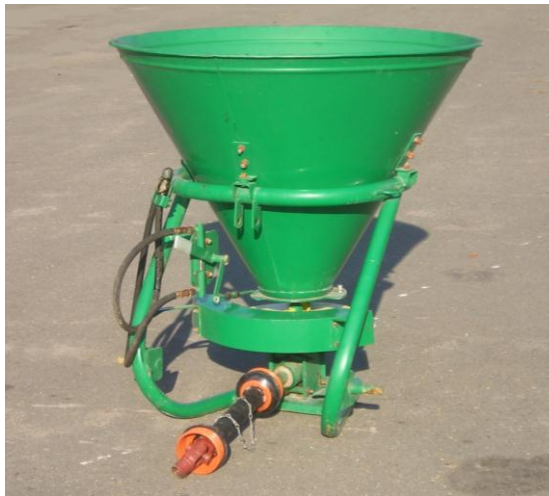
Рисунок 1 – Машина для внесення мінеральних добрив МВД-0,5 з одним тукорозсіваючим апаратом.
