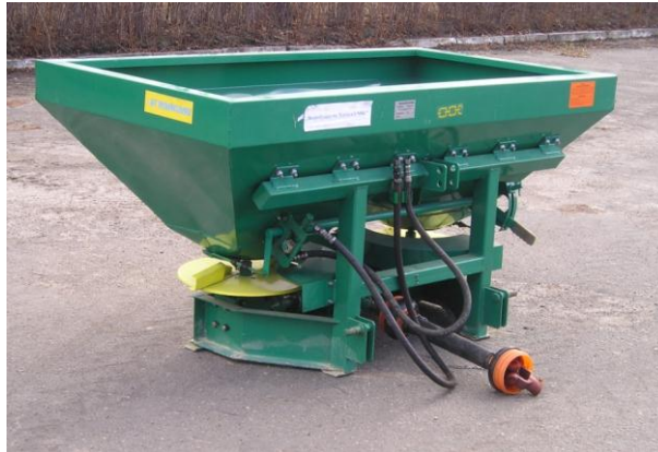
Рисунок 2 – Машина для внесення мінеральних добрив МВД-900 з двома тукорозсіваючими апаратами.
